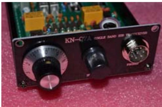
[ ] IF GAIN を中間程度にセットして調整を開始します。調整が完了したらケースの上蓋を閉じ4つのケース用ネジで固定するのを忘れないようにしてください。
