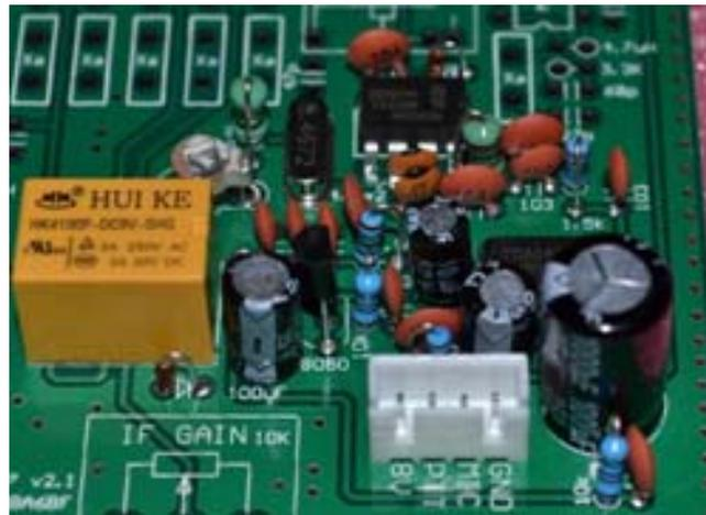
[ ] 12~13.8 V の安定化電源を接続し、PTT と GND をショートします。リレーが働くことを確認してください。BFO 周波数ゼネカバ HF 無線機を用意して漏れ電波を受信して 8.465MHz を確認してください。外部スピーカを接続し NE602A の1番ピンをピンセットで触ってスピーカからのノイズが大きくなることを確認してください。もし正常でない場合にはハンダ付けと NE602A の8番ピンに8Vが出ていることを確認してください。もしすべて OK ならスピーカと安定化電源を取り外し次のステップに進みます。
