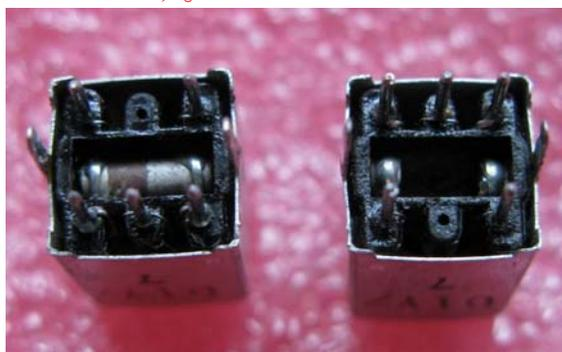
[ ] VXO 用クリスタルをハンダ付けしてください。基板との間にインシュレータを入れたり、クリスタルのケースをグランドにハンダ付けする必要はありません。クリスタルは周波数レンジに合わせ用途によって1,2個セットを選択いただきます。クリスタルが一個の時はもう一個の取り付け個所は空いたままになります。
