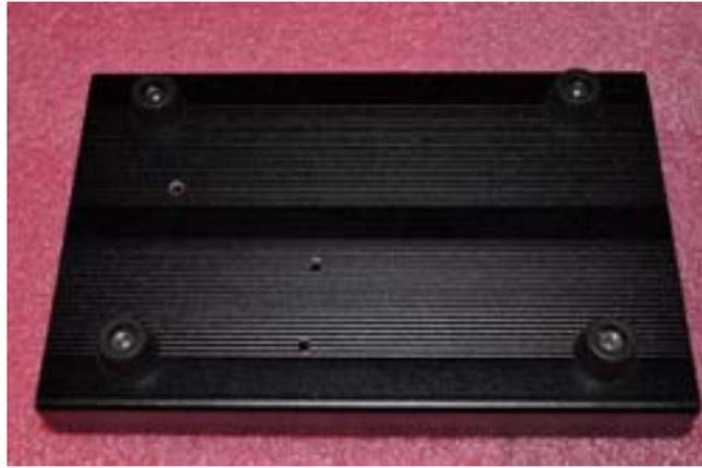
[ ] 4か所にゴム足を取り付けてください。ゴム足はネジの頭がケースの内側になります。4個の M3x10 ネジとナットを使います。
