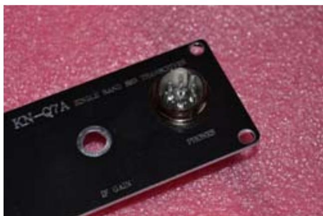
[ ] 下の図に基づいてマイクケーブルを接続します。このピン接続は ICOM の HM シリーズ、別売のマイクも合致します（但し信号レベルは高レベルのものが必要で TX Alignment で後述）。マイクを使用される場合には結線図を調べて正しく接続してください。SIP4 コネクタの結線は pin1 +8V、pin2 PTT、Pin3 MIC、pin4 GND です。基板上に Step3 の指示通りマイク端子（白プラスチック）をハンダ付けすると SIP コネクタの番号は逆になるので、現物合わせでマイクレセプタクルへの配線をお願いします（訳者注記）。スピーカーマイクを購入されている場合には基板上の SPK ランドからマイクのセンターピン(pin8)に線を一本接続してください。
