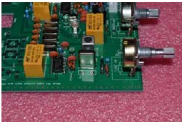
[ ] 12~13.8 V の安定化電源、スピーカを接続します。NE602A の1番ピンにピンセットで触れるかまたはアンテナ線を1番ピンに接触させてスピーカから大きな音が出るか確認してください。TUNE つまみを回して周波数が変化するとノイズの具合が変わります。VXO の発振は近接したゼネカバ受信機でもピックアップが可能です。正常でなければハンダ付けを確認してください。正常でない場合は NE602A の8番ピンに8V が来ているかを確認してください。OK ならば電源、スピーカを外し次のステップに進みます。
