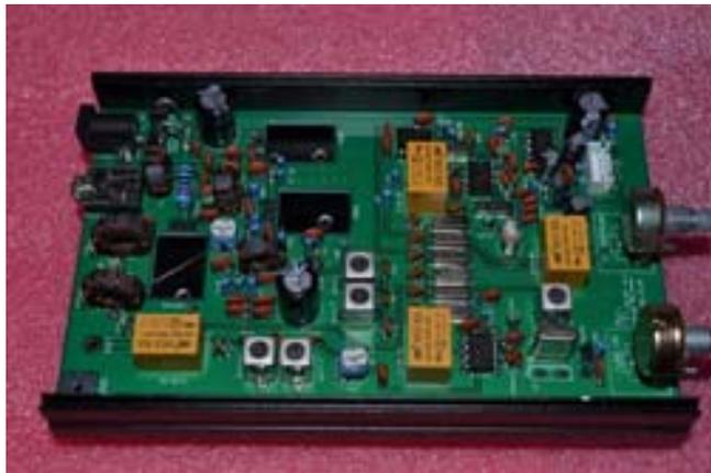
[ ] 7808, IRF640(14MHz 版は IRF530), D882の端子を画像にあるように折り曲げて加工します。IRF640は静電気で破壊される可能性がありますので注意して扱ってください。
