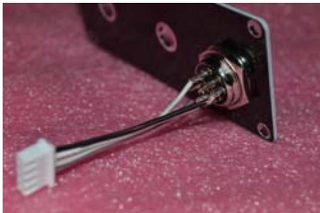
[ ] マイクケーブルを SIP4 ソケットで基板に接続し、2 個の黒いケース用ネジで固定します。最後にノブを取り付けてください。
