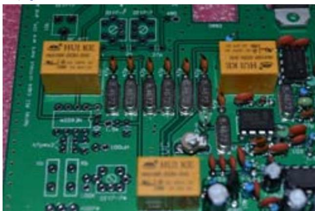
[ ] 2個のリレーをハンダ付けします。完了すると画像のようになります。
